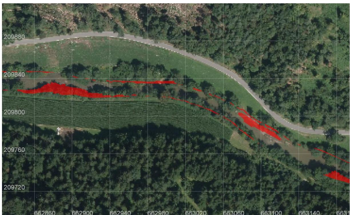
Abbildung 40: Beispielfläche Darstellung von berechneten Strandungsrisikoflächen (rot)
