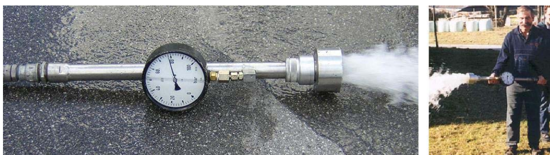
Abbildung 4: Störner-Düse zur Überprüfung des erforderlichen Wasserdurchflusses
